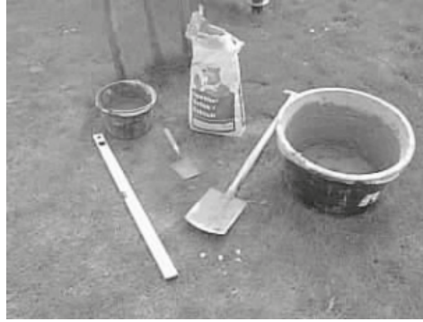
Mindestens erforderlich: Spaten, Estrichbeton, Betonkübel, Wasser, Wasserwaage.
