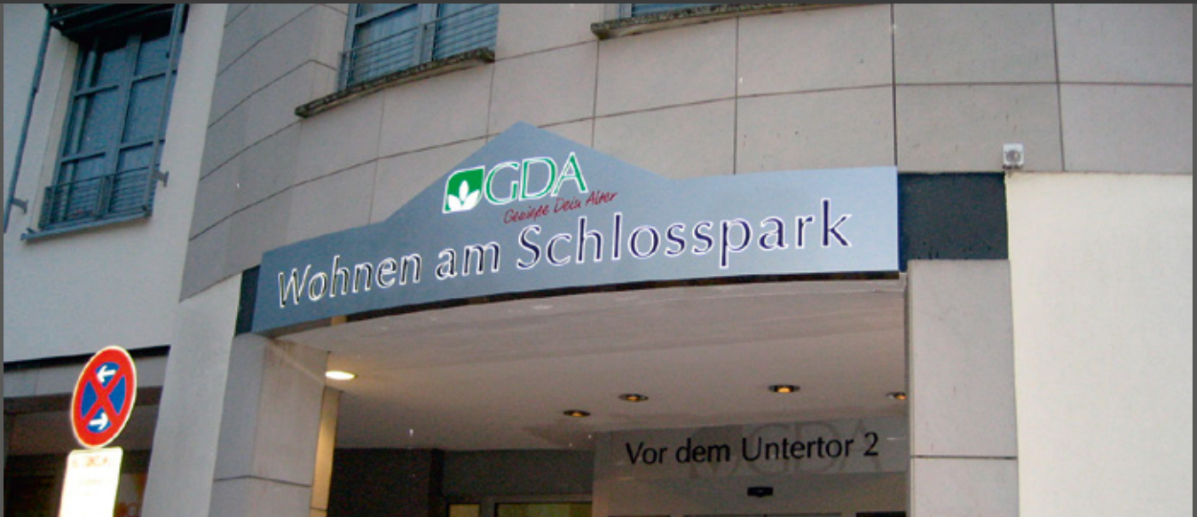
Leuchttransparent, Aluminiumgehäuse gewölbt und silber lackiert. Buchstaben ausgelasert mit Acrylglas hinterlegt und mit transluzenter Folie ausgelegt. Die Hinterleuchtung erfolgt durch hochwertige, energiesparende LED Technik.
